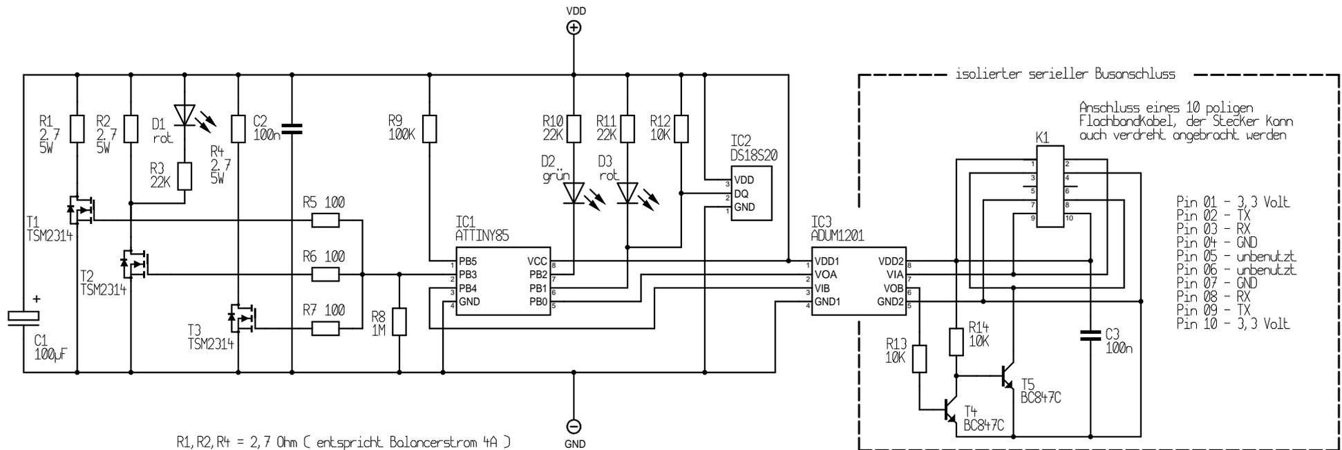
R1, R2, R4 = 2,7 Ohm ( entspricht Balancerstrom 4A )
